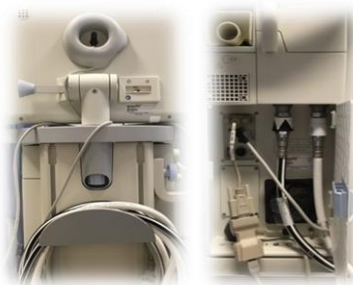
Figura 4. Panel posterior interfaz de usuario (izquierda) y lateral de conexiones (derecha) del Servo-i de Maquet.
